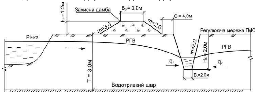
Рис. 2. Схема регулювання притоку ґрунтової води з відкритих водойм на польдерній системі (на перетині А-А, див. рис. 1) за допомогою відкритих каналів
