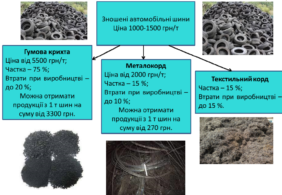
Рис. 1. Види продукції, які отримують зі зношених а втомобільних шин (ціни станом на 2016 рік)
