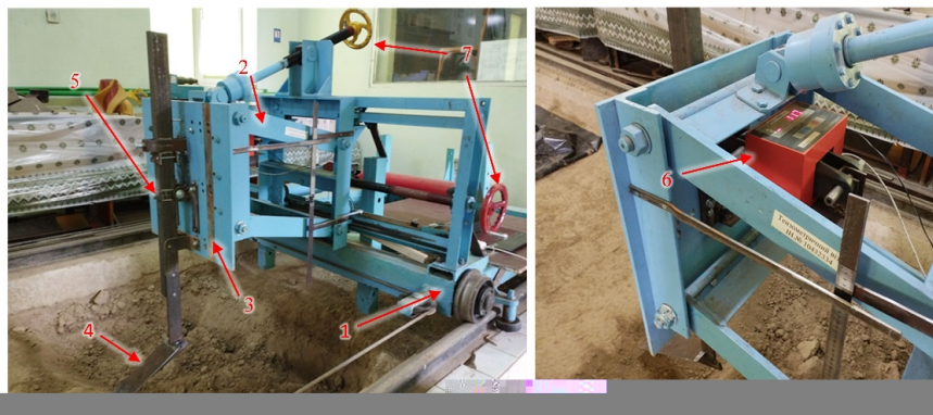
Рис. 1. Загальний вигляд ґрунтового каналу з динамометричним візком та дослідним обладнанням
