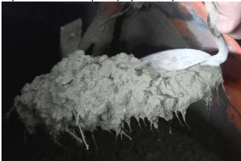
Рис. 1. Приготування бетонної суміші із комбінованого фібробетону в змішувачі примусової дії (поліпропіленовою та сталєвою фіброю)
