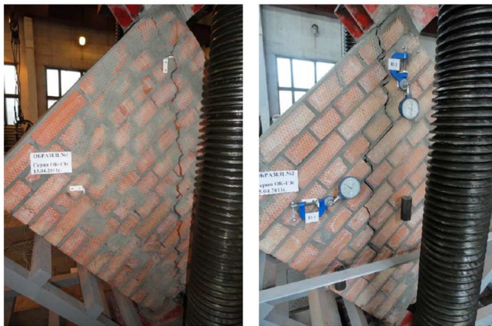
Рис. 1. Схеми випробувань зразків на дію горизонтального та вертикального навантажень
