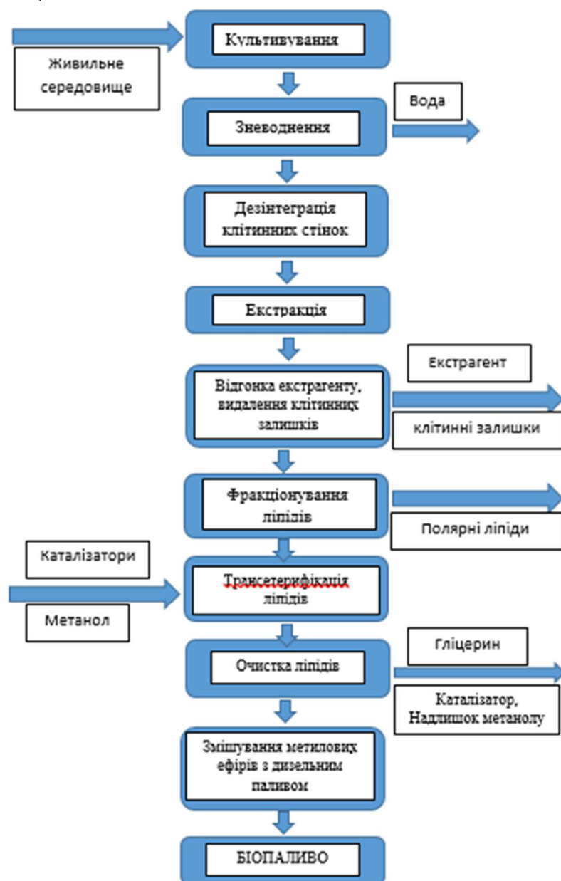
Рис. 4. Блок-схема виробництва біодизеля з олії мікрободоростей [15]
