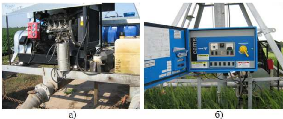
Рис. 10. Зовнішній вигляд ДМ «Valley», оснащеної технічними засобами: а – ємність для вимірювання палива на ДМ «Valley»; б – пульт керування ДМ «Valley»
