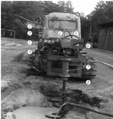
Рис. 1. Установка для виконання польових досліджень у робочому положенні (вид ззаду): 1 – гідромотор; 2 – тензоланка; 3 – гусеничний трактора ДТ -75Д; 4 – муфта; 5 – редуктор; 6 – рама; 7 – приводна колонка; 8 – фреза; 9 – гнучкі трубопроводи
