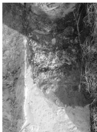
Рис. 9. Слід утворення пульпи із перевищенням допустимих швидкостей
