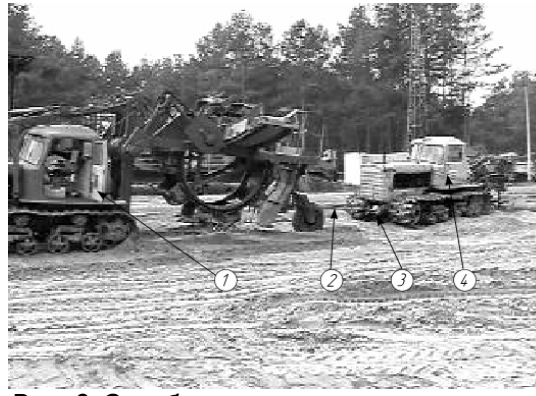
Рис. 2. Засоби експериментальних досліджень шляхом прямої тяги: 1 – тягач ЕТР-162; 2 – буксирний канат; 3 – динамометр; 4 – трактор ДТ-75Д з фрезерним робочим органом
