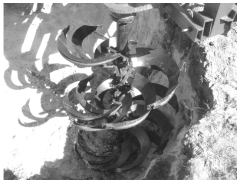
Рис. 7. Ґрунторуйнівні елементи фрези
