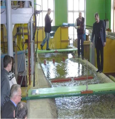
Рис. 1. Лабораторні модельні дослідження донних порогів на р. Дністер в м. Старий Самбір Львівської обл.
