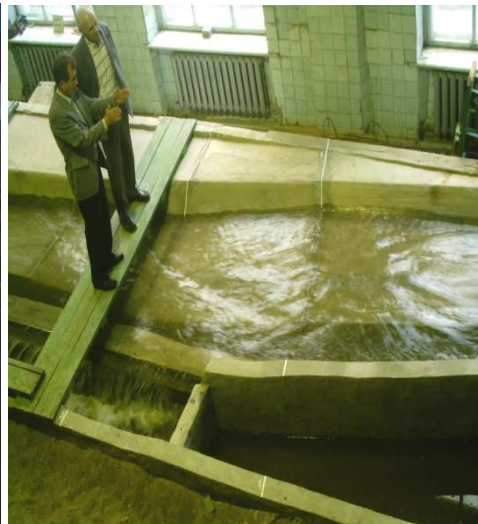
Рис. 4. Лабораторні дослідження водозабору протипаводкової акумулюючої ємкості «Тершаків» на р. Бистриця у Львівській області
