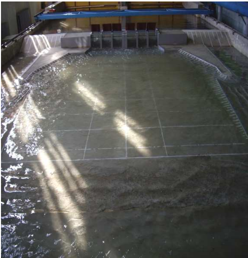
Рис. 3. Лабораторні дослідження протипаводкової акумулюючої ємкості на р. Тиса в Закарпатській області
