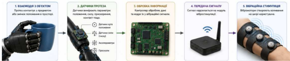
Рис. 1. Суть підходу вібраційного зворотного зв'язку
