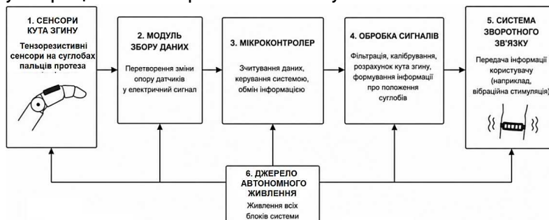
Рис. 5. Структура пропонованої системи штучної пропріоцепції
