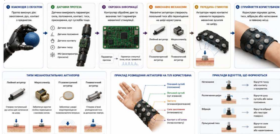
Рис. 3. Суть механотактильного зворотного зв'язку
