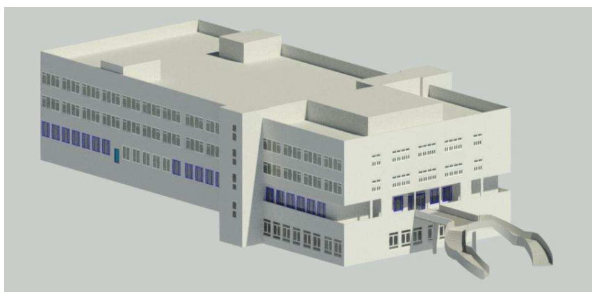
Рис. 4. Опрацьований зовнішній вигляд моделі, одержаний за хмарою точок з БПЛА
