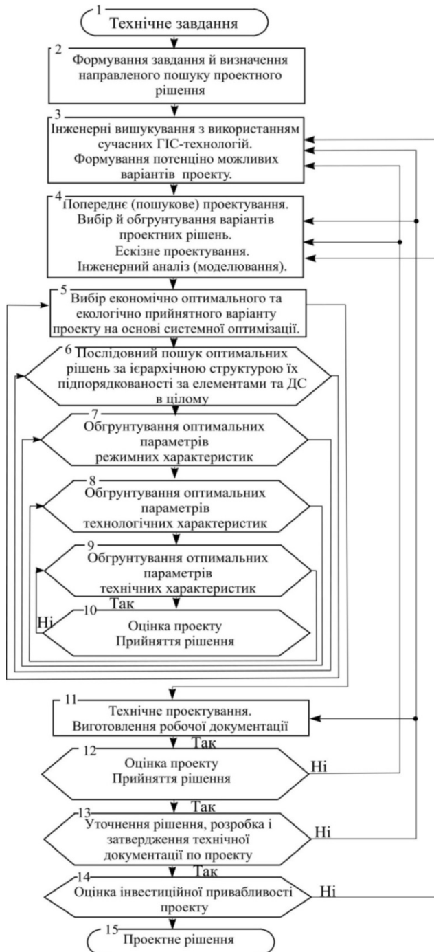
Рис. 2. Типова логічна схема процесу проектування за базовими проектними процедурами на багатоваріантній основі за системною оптимізацією
