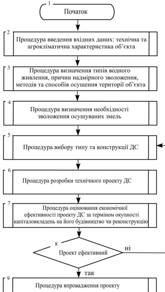
Рис. 1. Структурна блок-схема обґрунтування типу та конструкції ДС на моноваріантній основі
