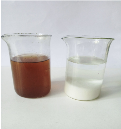
Рис. 7. Очистка та знебарвлення стічної води від кислотної рафінації рослинної олії внаслідок обробки хлорним вапном
