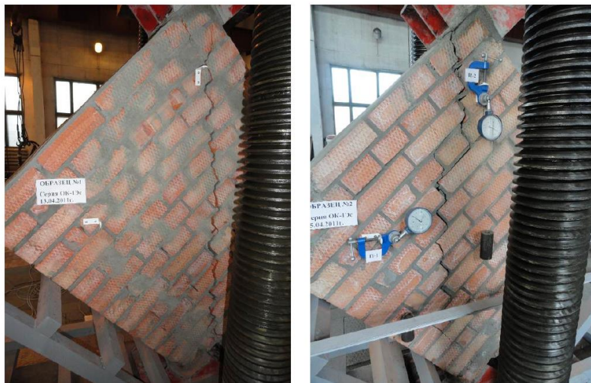
Рис. 2 - Руйнування зразків від дії статичної сили
