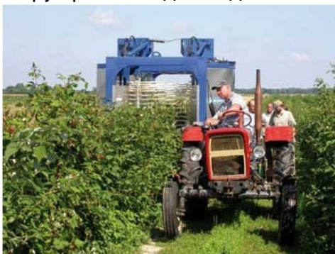
Рис. 9. Комбайн з вертикально розміщеним вібраційним отрушувачем для збору ягід малини
