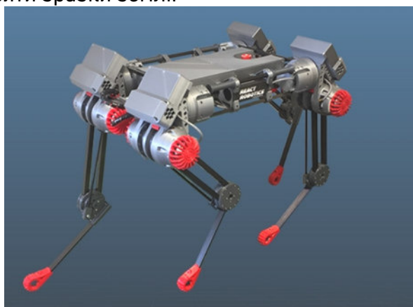
Рис. 6. Загальний вигляд розробки DogBot (компанія React Robotics )
