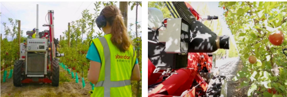
Рис. 5. Збір урожаю яблук автономним роботом Abundant Robotics
